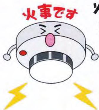
火災により発生する煙や熱を感知し、音や音声で知らせてくれる機器
